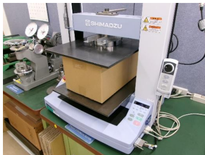
段ボール箱圧縮試験 ASTM D 4169, ISTA荷重保持
