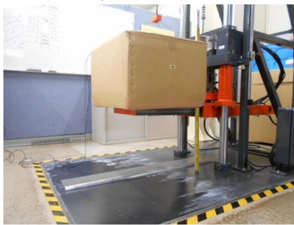
落下試験－試験状態（2回目）
